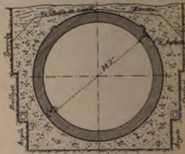
Fig. 210. — Type en tranchée couverte.
